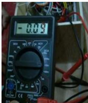
Gambar 13. Hasil Pengukuran Arus pada saat motor OFF
